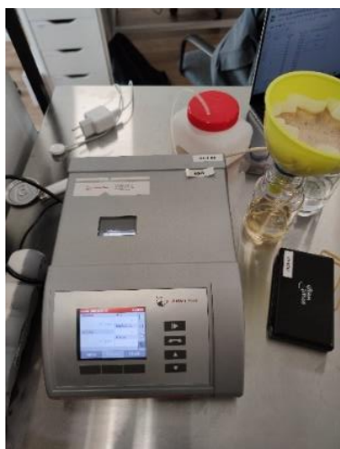
Figure 23 : Alcool mètre et analyseur d'extrait Alex 500 (Bellenguez.M, 2022)
