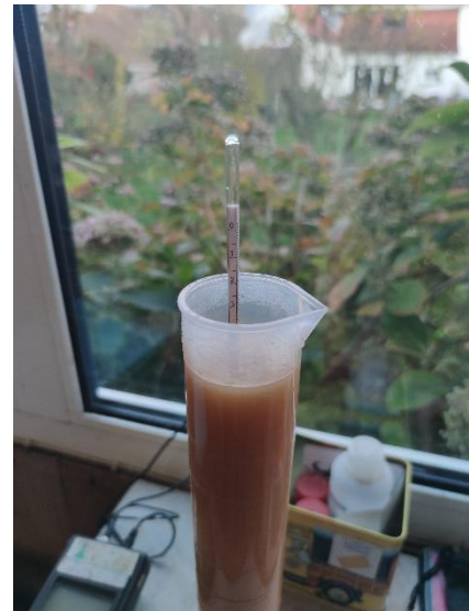
Figure 6 : Prise de densité avec un densimètre (Bellenguez M. 2020)
