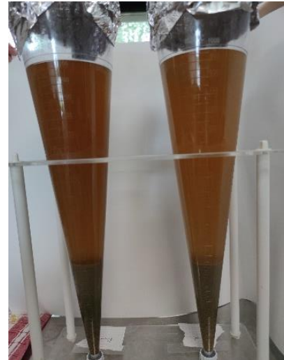
Figure 17 : Moûts de 60 min (à gauche) et 45 min (à droite) dans les cônes d'Imhoff (Bellenguez.M, 2022)
